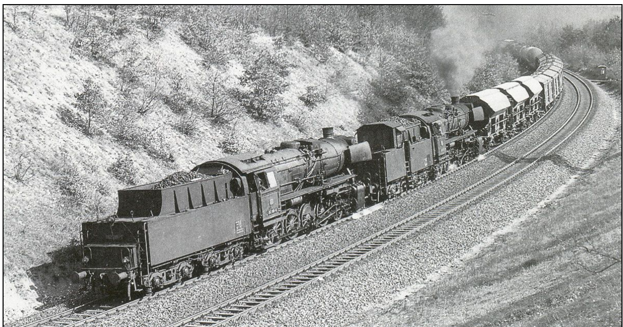
Und nochmals ein Pärchen: Da die 50er in Rückwärtsfahrt die gleiche Höchstgeschwindigkeit erreichen und der normale Tender auch eine gute Sicht für den Lokführer bietet, spielt die Laufrichtung keine Rolle. Nur für das Auge des Betrachters ist es eher ungewöhnlich.
