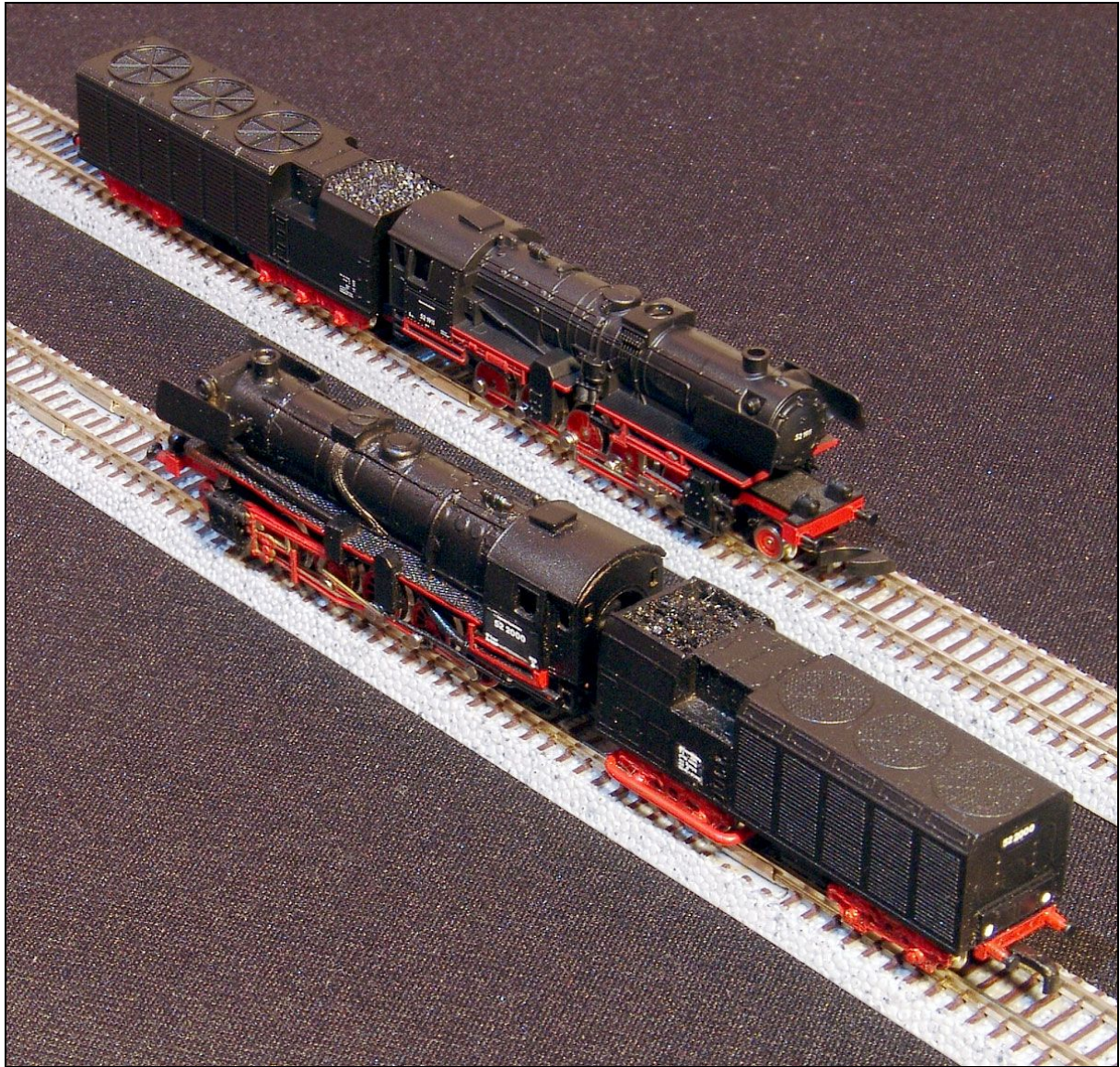
Die Gegenüberstellung des Westmodel-Modells mit dem Märklin-Modell offenbart die beiden Kondensstendervarianten: Vorne der "kleine", vierachsige, und hinten der "grosse", fünfachsig Kondensstender.
