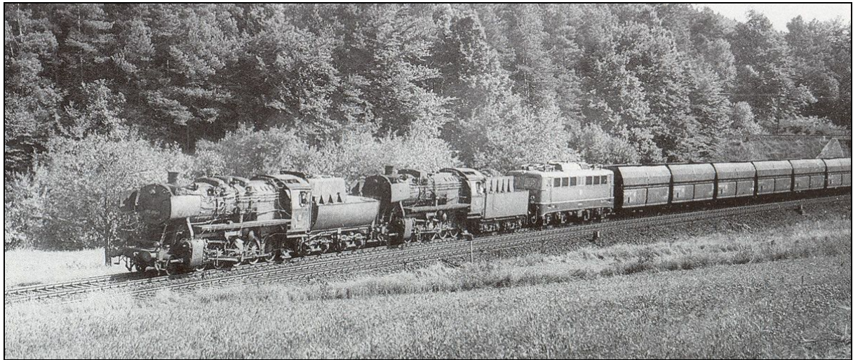
Interessante Kombination: Auf der 1973 noch nicht elektrifizierten Strecke Kaiserslautern – Bad Kreuznach braucht der umgeleitete Ganzzug mit der E 40 zwei 52er als Vorspann.
