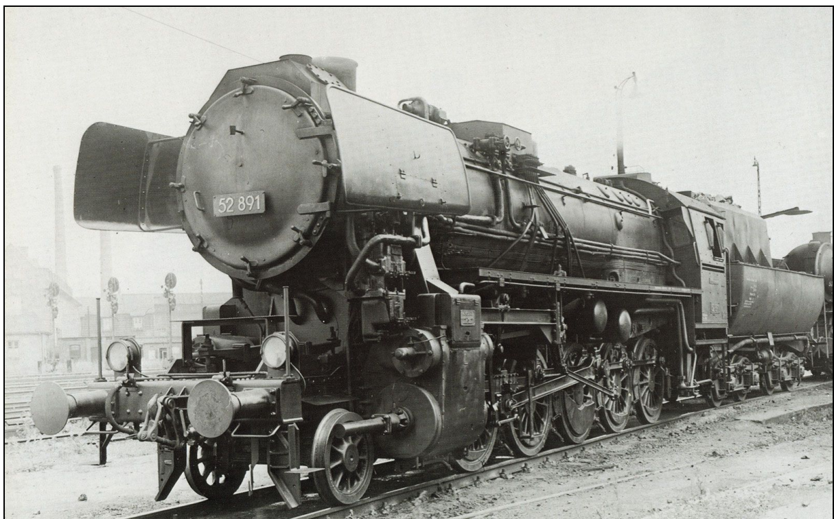
Auch nach Kriegsende wurden noch neue BR 52 an die DB ausgeliefert. An ihnen wurden auch neue Bauteile, wie der eckige Heiñl-Mischvorwärmer an der 52 891 erprobt.
