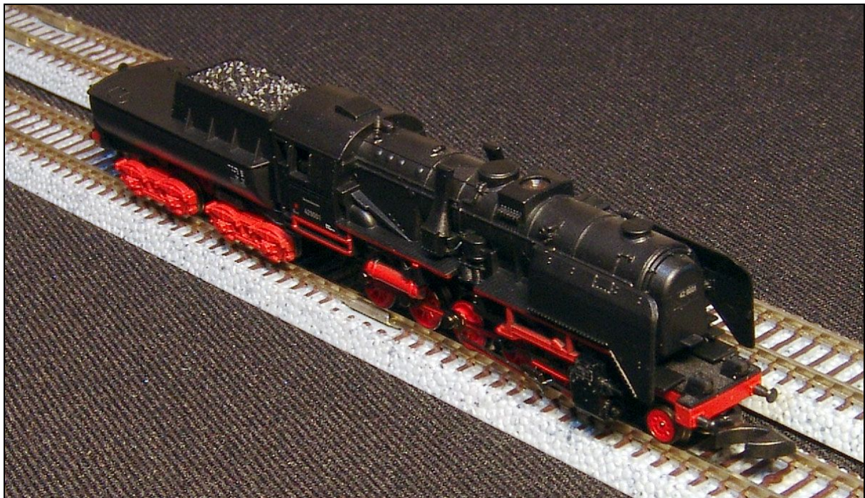
Eigentlich ist die hier auch eine Variante der BR 52! Von der Firma Henschel wurden noch im Jahre 1951 zwei Lokomotiven der BR 52, die 52 893 und die 52 894 an die DB geliefert. Sie wurden mit Franco-Crosti-Abgasvorwärmern ausgerüstet, um dieses Verfahren zu erproben. Da durch diese baulichen Änderungen die Achslast auf 20 t angestiegen war, erhielten sie die Baureihenbezeichnung 42.90 .
