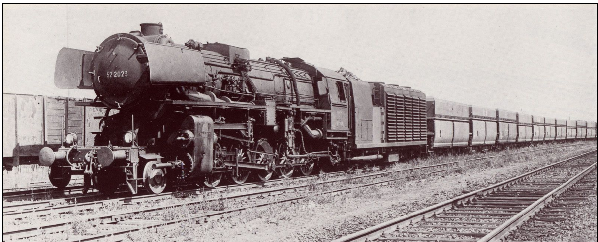
Der lange Kondensender lässt die 52 viel wuchtiger wirken als der vergleichsweise schmächtige Wannentender. Hier die 52 2023 mit einem Ootz-Ganzzug am 23. August 1950 in Minden.
