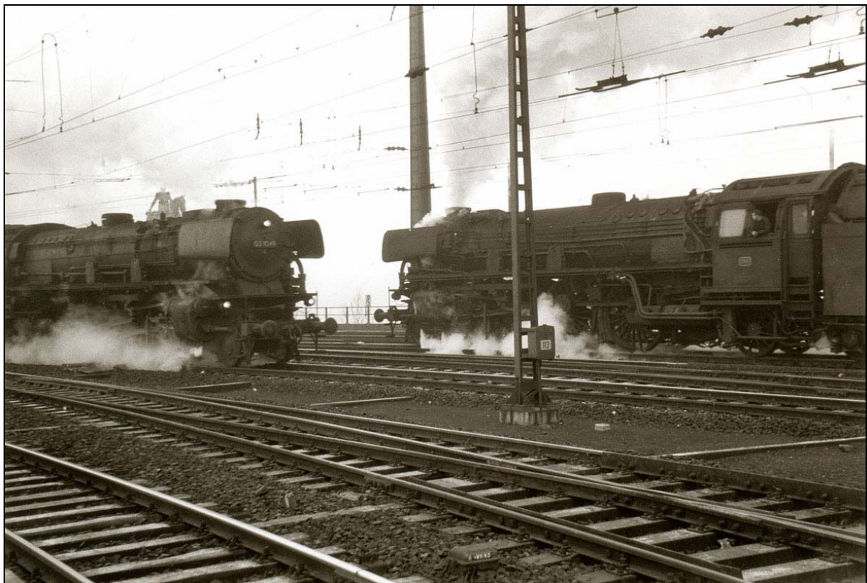
Zwei 03.10er begegnen sich in Köln Hbf. Während die linke Maschine eindeutig als 03 1049 identifizierbar ist, fehlt bei der rechten Lokomotive das entsprechende Schild. Beide Loks besitzen Neubaukessel, die in den Jahren 1957 – 59 eingebaut wurden. Dennoch schieden die störungsanfälligen 03.10 einige Jahre vor den Ursprungs-03ern aus dem Betriebsdienst.
